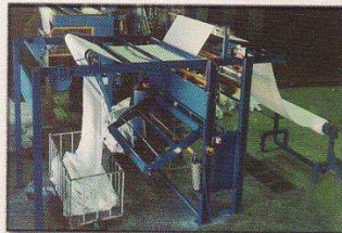
دستگاه باز کن سریع و مهیا ساز پارچه خام بصورت خرک و لامتر مدل چهارمحال
